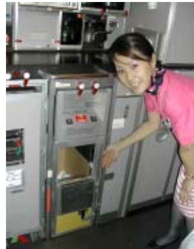
B747-400 機内設置の ごみ圧縮器(タッチコンパクター)
