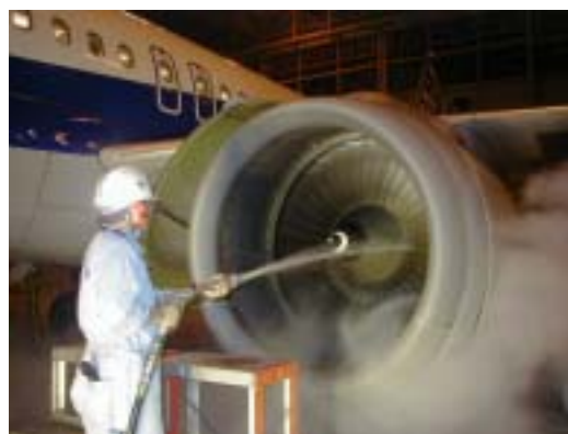
写真は、A320のエンジン水洗トライアルです。B777では専用装置を使って水洗します。
