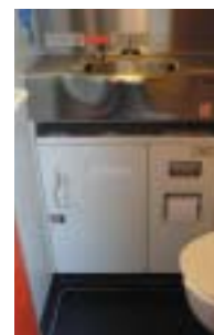
車いす使用者用化粧室 機内用車いすで使用可能、一部機種を除き設置
