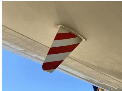
VHFアンテナカットアウト
