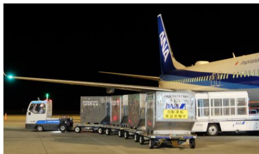
【昨年10月、九州佐賀国際空港でのトーイングトラクター自動走行実証実験の様子】
